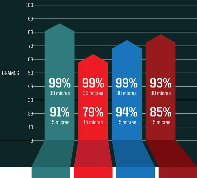
Prueba ISO 4548-12 Flujo de Aceite: 28 gpm Terminación: 25 PSID
